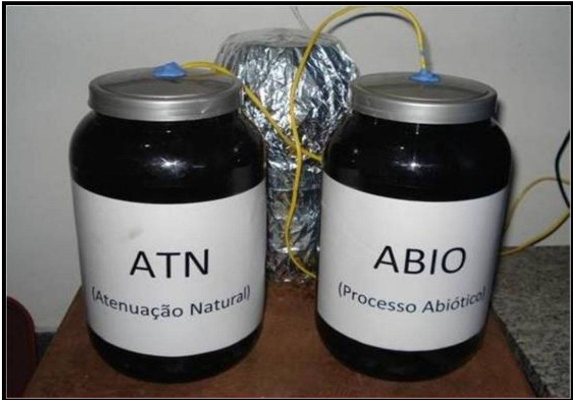
Figura 17. Biorreatores de bancada sem aeração forçada.
