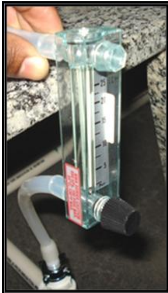
Figura 19. Rotômetro de marca Dwyer utilizado para controlar a vazão de ar na entrada de cada biorreator piloto.
