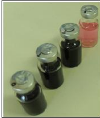
Figura 14: Exemplificação do método de quantificação por NMP: os frascos escurecidos indicam a presença de BRS nas diversas diluições
