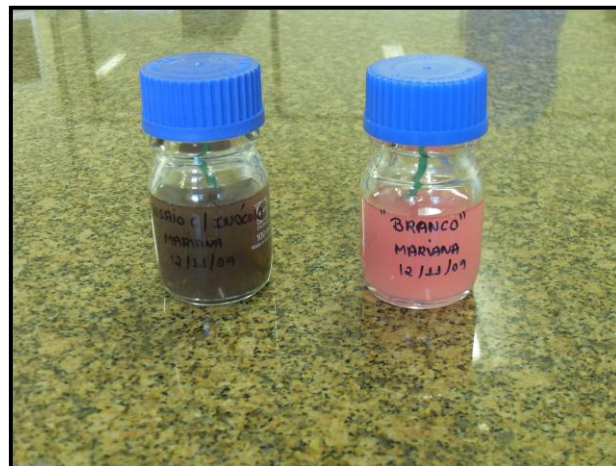
Figura 13: Reatores representativos do ensaio de polarização com 7 dias de exposição: com inóculo (esquerda) e sem inóculo (direita)
