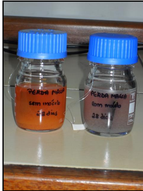
Figura 12: Reatores utilizados nos ensaios de perda de massa com 28 dias de exposição: sem inóculo (esquerda), com inóculo (direita)
