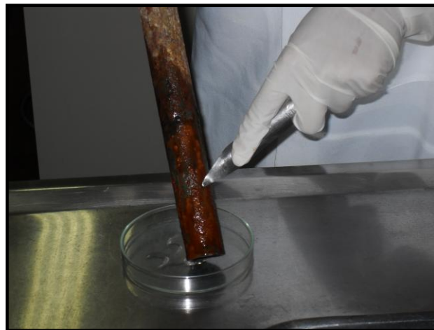
Figura 11: Tubulação com produtos de corrosão
