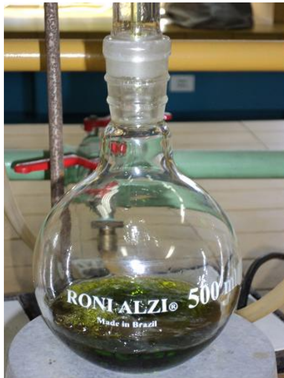
Figura 20. Extração da fração lipídica com uma mistura de clorofórmio/metanol realizado durante 4h
