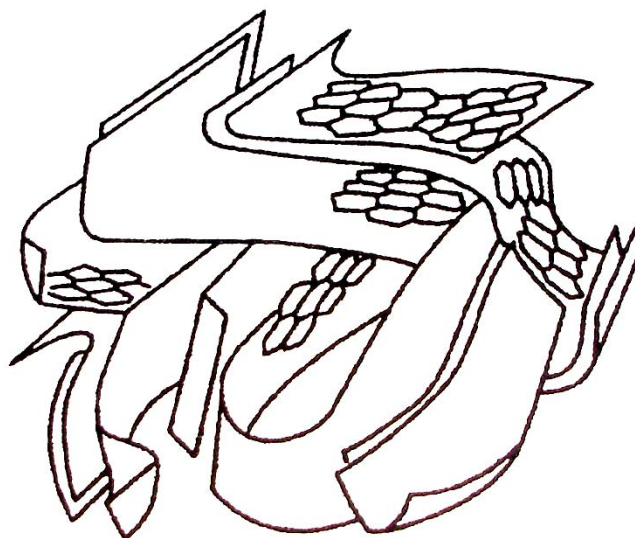
Figura 18 - Esquema da estrutura de um carvão ativado (FRAGA, 2000).
