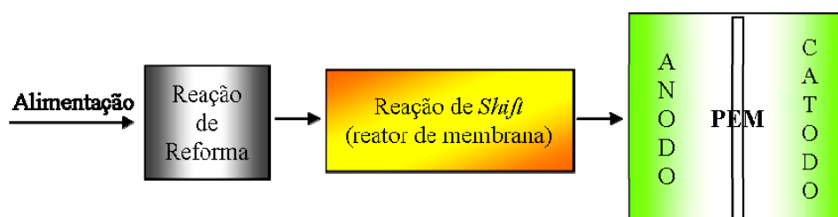
Figura 7 - Esquema do sistema PEM baseado na reação de shift utilizando um reator de membrana. (Adaptado de MANZOLINI, 2008)
