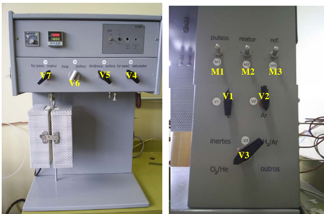
Figura 33 – Vistas frontal e lateral direita da unidade de TPD-NH 3
