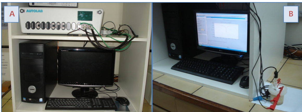
Figura 17: (A) Fotografia do potenciostato AUTOLAB PGSTAT302N utilizado nestes ensaios; (B) Exemplo de ensaio de polarização realizado com uma célula de trabalho confeccionada para esta finalidade.
