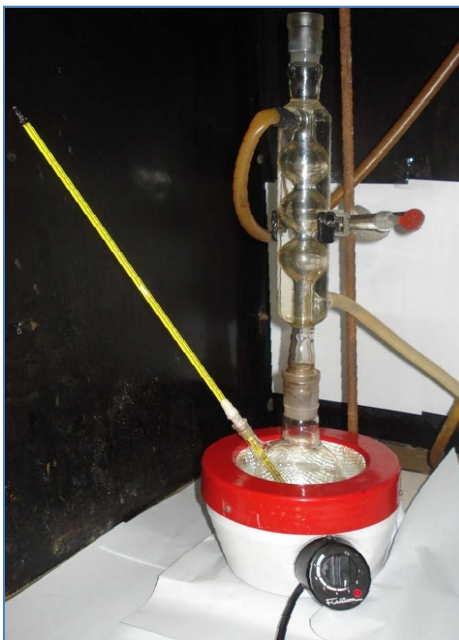
Figura 14: Esquema de aquecimento sob refluxo usado nos experimentos para simular as condições de retortagem.
