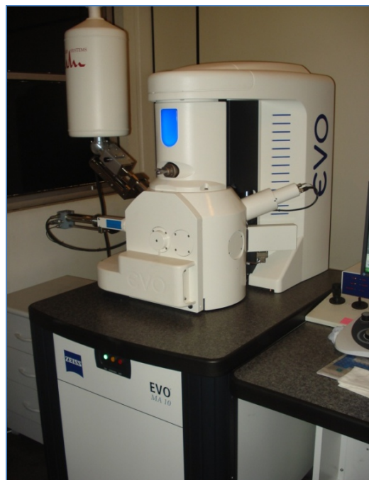
Figura 15: Vista geral do microscópio eletrônico de varredura – CARL ZEISS EVO MA 10. (DEPA – FGEL – UERJ).
