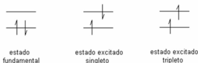
**Figura 1:** Representação do estado fundamental e dos estados excitados singleto e tripleto (COELHO, 2004)
