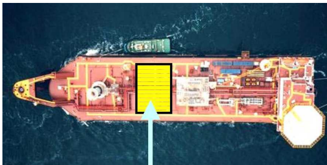
Figura 97 - Ilustração do espaço necessário para uma planta de 1.000 bl/d de capacidade. Fonte: BRANCO, 2008.
