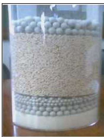
Figura 76 – Modelo do leito de peneira molecular. Fonte: VAZ et al., 2008.
