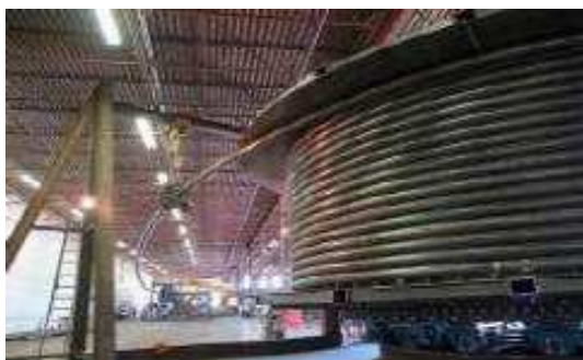
Figura 85 - Tubo sendo enrolado na estrutura carrossel (tecnologia Coselle®). Fonte: SEA NG, 2008.
