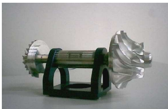
Figura 71 – Conjunto rotativo de um turbo-expansor. Fonte: VAZ et al., 2008.
