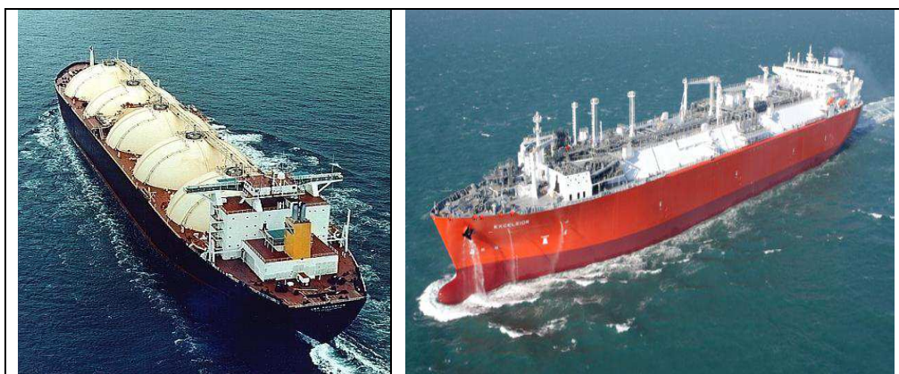
Figura 82 - Navio de transporte de GNL com cinco tanques esféricos (MOSS). Fonte: ABS, 2006.
