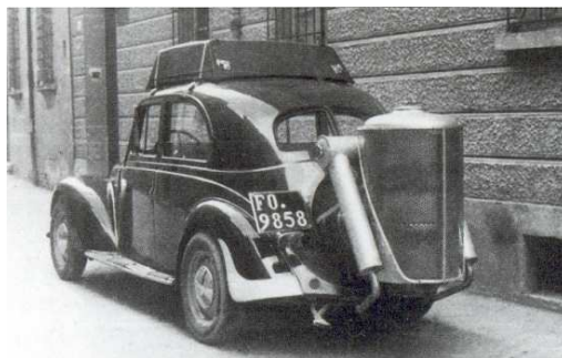
Figura 39 - Veículo europeu equipado com reator de gás de síntese. Fonte: Wikipédia, 2002.
