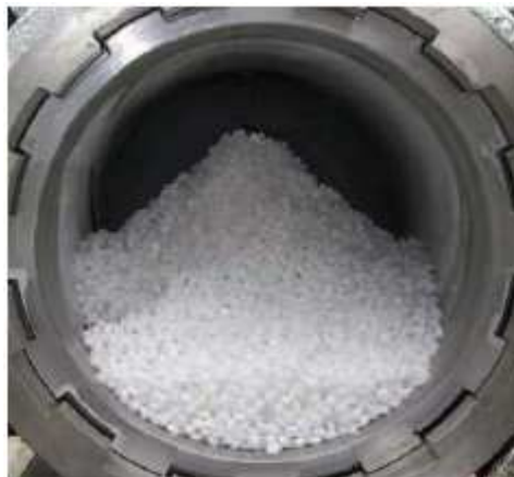
Figura 110 - Hidrato de gás natural na forma de pellets . Fonte: WATANABE, 2008.
