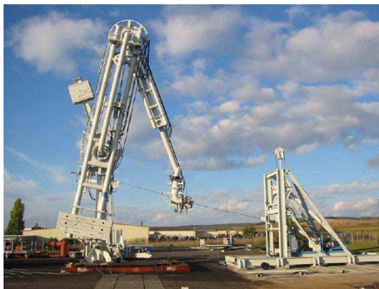
Figura 81 - Braço de carregamento de GNL no banco de testes dinâmicos da FMC. Fonte: DEVEHAT, 2008.
