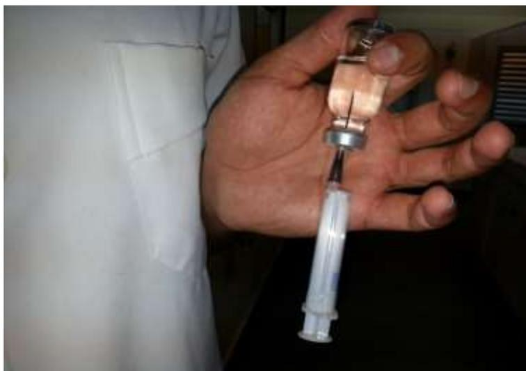
Figura 6: Procedimento de amostragem do líquido no frasco de vidro.
