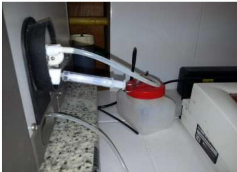
Figura 7: Procedimento de injeção de amostragem do densímetro Anton Paar DSA 5000.
