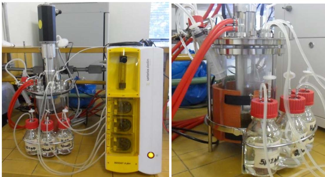
**Figura 19 – Biorreator *Biostat A Plus* da *Sartorius* em operação.**
