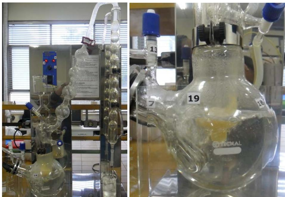
**Figura 20 – Microdestilador *Tecna* TE-012 em operação.**
