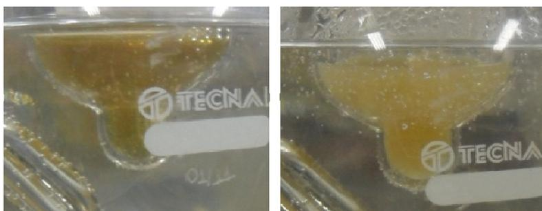
**Figura 18 – Mosto centrifugado não esterilizado antes e depois de aquecimento dentro do microdestilador.**
