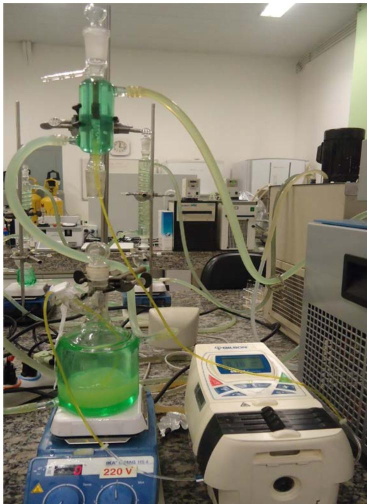
**Figura 2.2** Sistema reacional com reator de leito fixo
