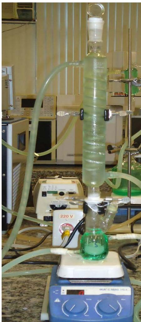
**Figura 2.1** Sistema reacional com reator batelada
