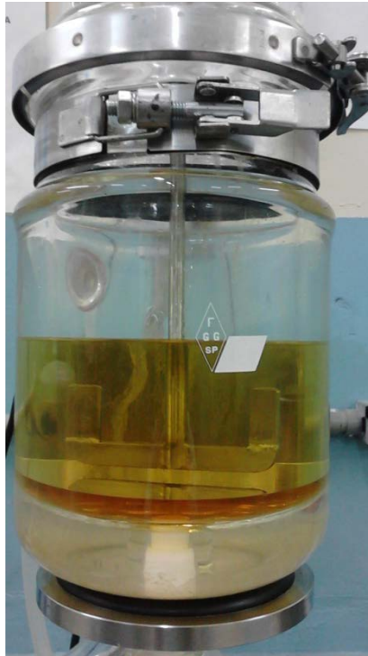
Figura 10: Reator de síntese com os produtos finais da transesterificação: o biodiesel na fase superior e a glicerol, em tom castanho, na fase inferior.
