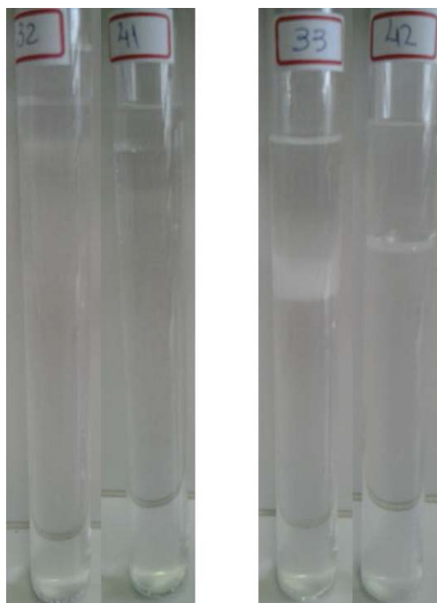
Figura 44: Emulsões de n-Hexadecano, metanol e água (composições conforme Tabela 21).
