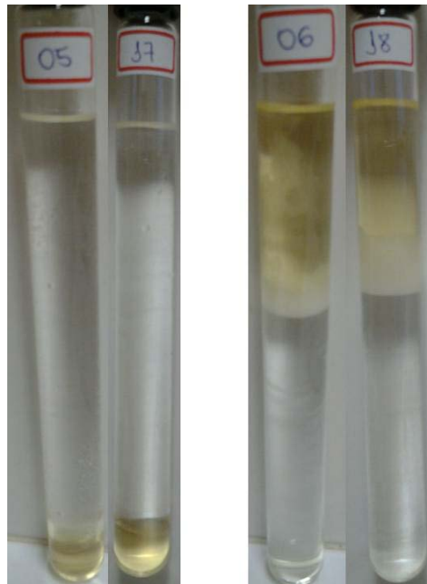
Figura 38: Emulsões de biodiesel sintético, etanol e água (composições conforme Tabela 16).
