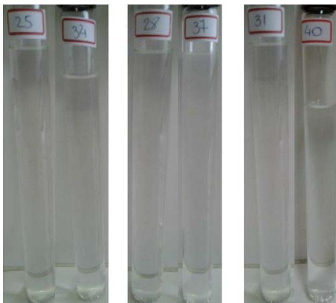
Figura 41: Misturas monofásicas dos oleatos de metila e de etila, e do n-hexadecano, respectivamente, após 15 dias (identificação e composições conforme Tabela 2).
