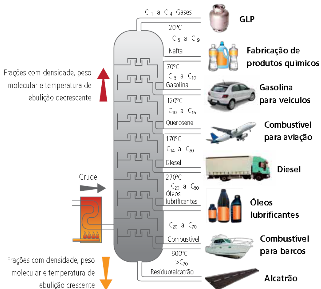
Figura 1: Representação esquemática de uma coluna de destilação de petróleo, com as principais frações de saída. Fonte: CNT (2012).
