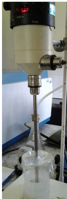
Figura 13: Preparo da emulsão, com agitador mecânico e película de PVC.
