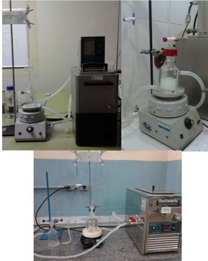
Figura 12: Circuito montado para titulação, composto por um agitador magnético, a célula encamisada, bureta e seu suporte para o titulante, e o banho de controle de temperatura. As imagens superiores são no LaTemA/IQ/UERJ (fora e dentro da capela de exaustão) e a imagem inferior é na FaT/UERJ.
