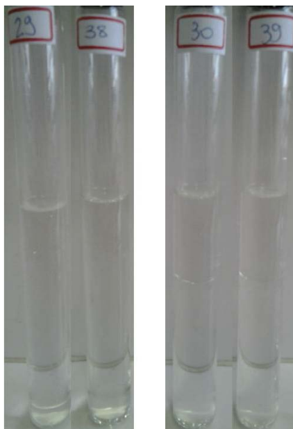
Figura 43: Emulsões de oleato de etila, etanol e água (composições conforme Tabela 20).
