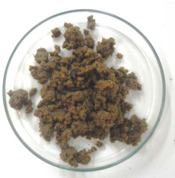
Figura 3.4 - Aspecto do sólido após a hidrólise ácida realizada em planta piloto
