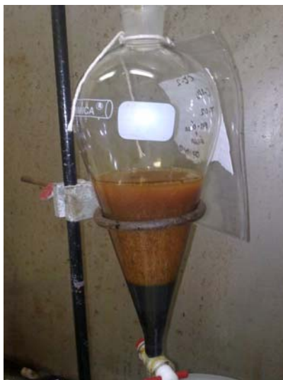
Figura 3.5 – Separação das fases do efluente líquido do teste C.39T.05.
