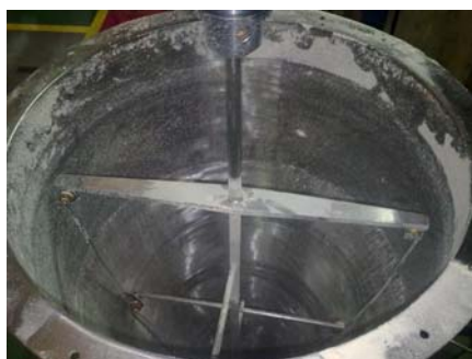
Figura 2.18 – Detalhe do raspador instalado no silo de carregamento.
