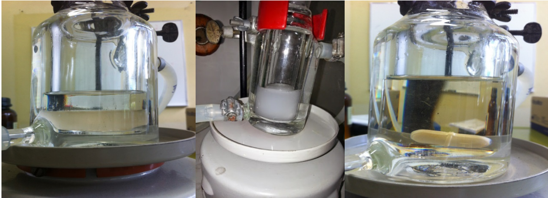
Figura 7 - Sistema com duas fases (à esquerda) e uma fase (à direita); no centro é apresentado o efeito da agitação com turvação.
