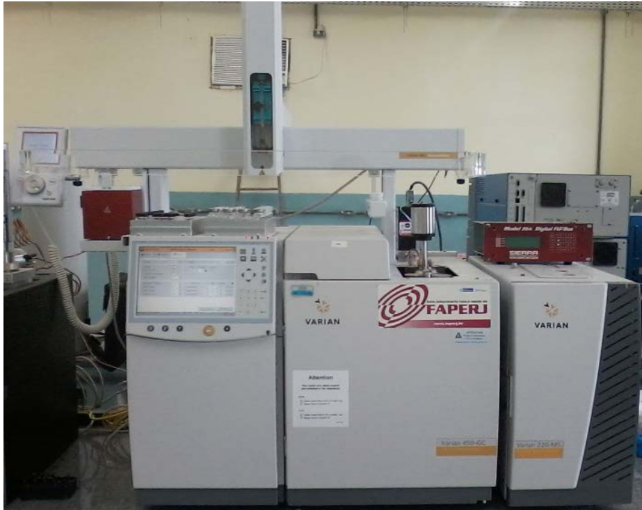
Figura 9 – Cromatógrafo de fase gasosa Varian (modelo 450) acoplado a um espectrômetro de massa Varian (modelo 220).
