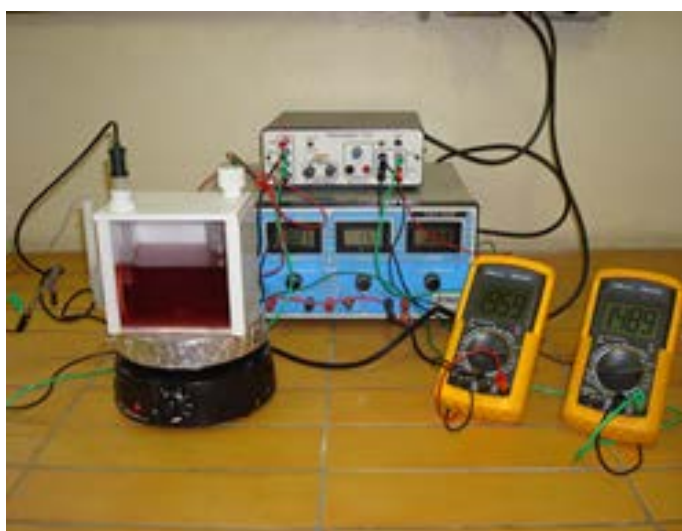
Figura 12 – Sistema utilizado para os ensaios de polarização galvanostática e eletrodeposição no potenciostato/galvanostato PT-05.
