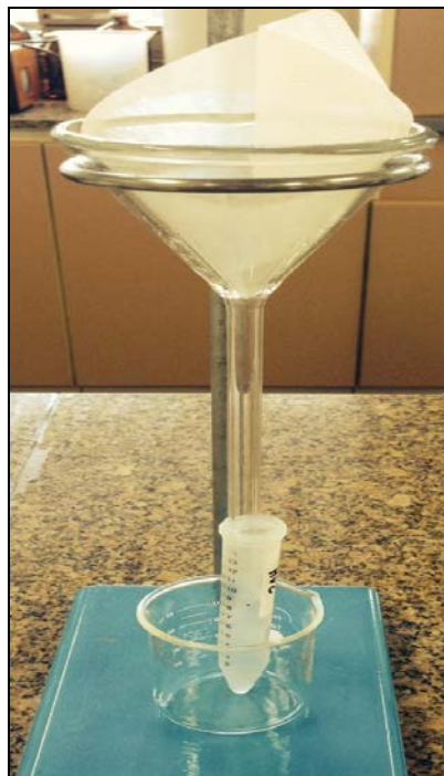
Figura 17 - Unidade de Filtração.
