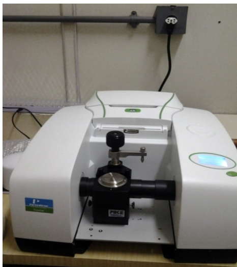
Figura 7 - Espectrômetro de IV com acessório de Reflectância Total Atenuada (ATR).
