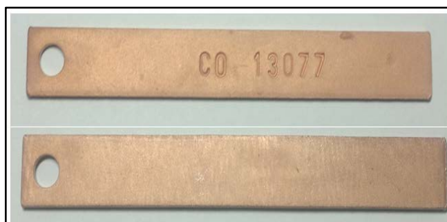
Figura 13 – Eletrodo de trabalho de cobre eletrolítico utilizado nos ensaios de imersão total.
