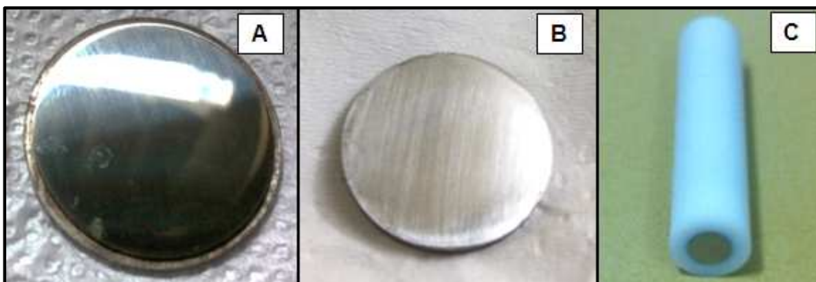
Figura 13: Eletrodos de Trabalho utilizados para a realização dos experimentos (A) Eletrodo 1 com área exposta de 5,31 \times 10^{-4} \text{ m}^2 , (B) Eletrodo 2 com área exposta de 2,54 \times 10^{-4} \text{ m}^2 , (C) Eletrodo 3 com área exposta de 7,85 \times 10^{-5} \text{ m}^2 , embutido em uma ponteira de teflon.
