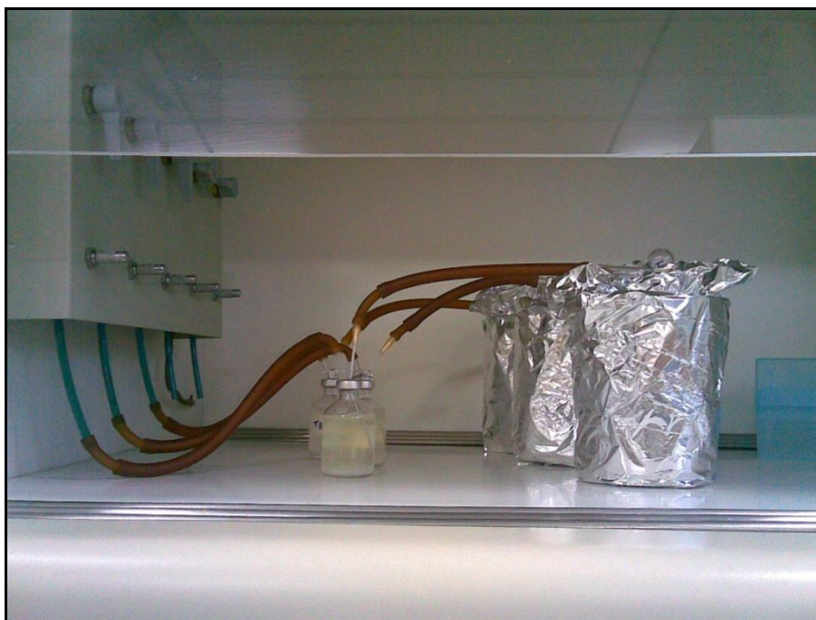
Figura 12 - Esquema do arraste do sulfeto biogênico das amostras
