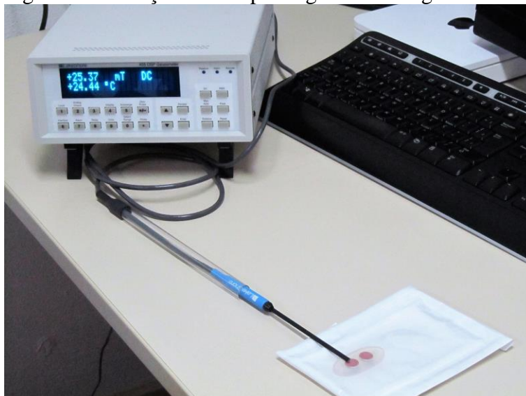
Figura 3 – Medição do campo magnético com gaussímetro
