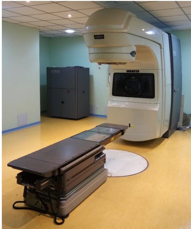
Figura 20 - Acelerador linear Clinac Varian 21 EX com duas energias de fótons (6MV e 10MV)
