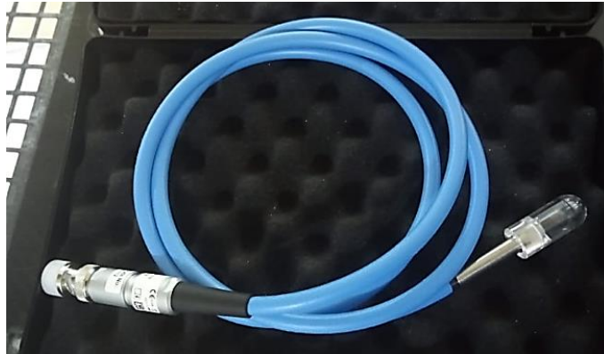
Figura 21 - Câmara de ionização semiflex 0,125cm 3 TN31010 PTW
