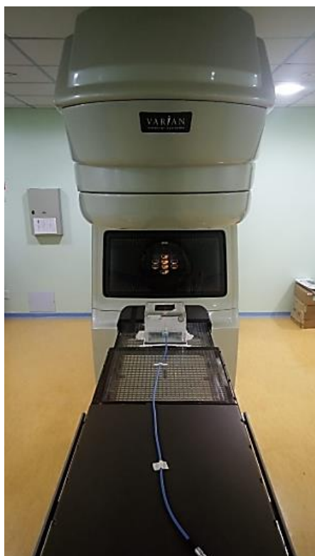
Figura 84 - Cabos fixado à mesa do acelerador com auxílio de fita adesiva / teste 5
