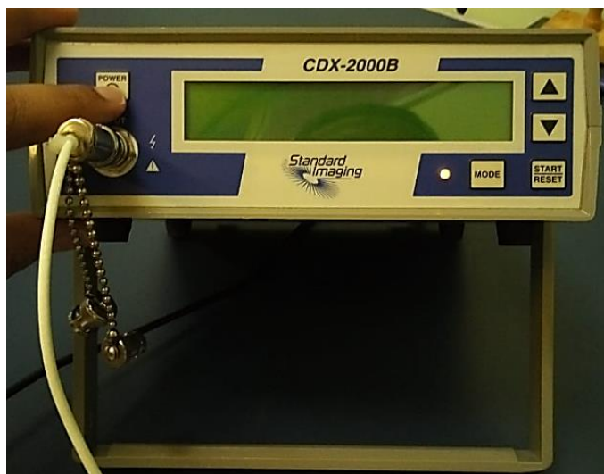
Figura 78 - Posicionamento do eletrômetro sobre a bancada da área de comando
