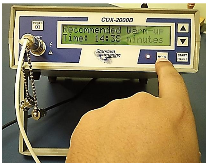
Figura 86 - Esperar 15 minutos de aquecimento para o eletrômetro
