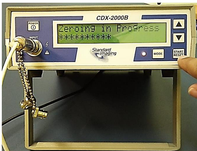
Figura 87 - Zerar o tempo de aquecimento do eletrômetro
