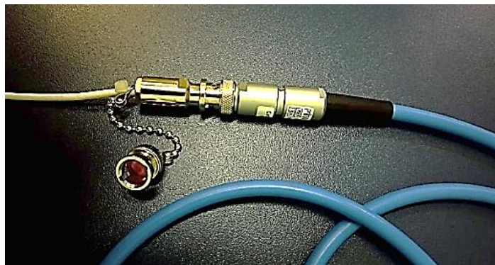
Figura 83 - Conector do cabo da câmara de ionização ligado ao outro conector do cabo que faz a ligação com o eletrômetro
