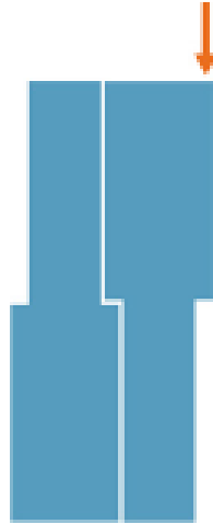
Figura 3: Ilustração das lâminas do MLC com o design do tongue-and-groove.
