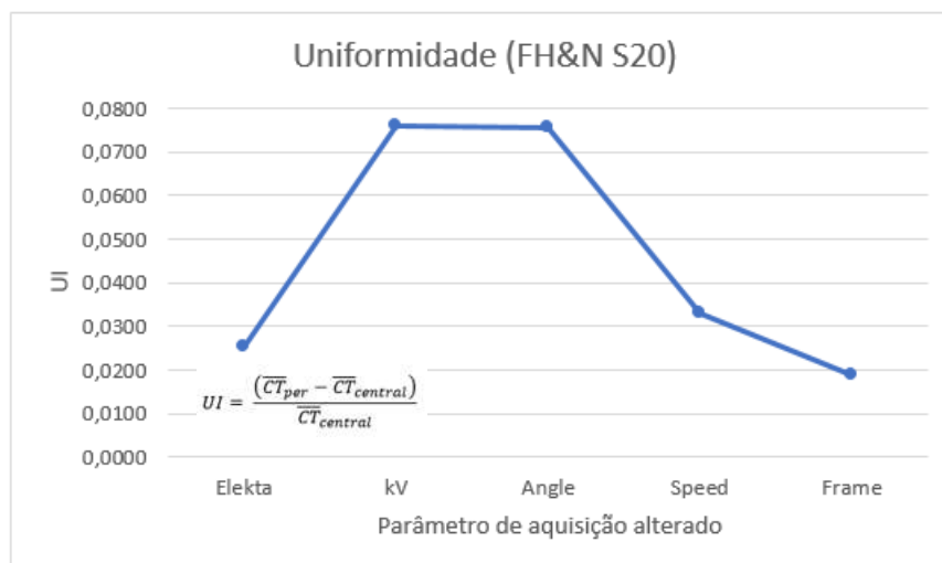
Figura 39 – Gráfico dos resultados para Uniformidade do preset clínico Fast Head & Neck S20 e presets modificados
