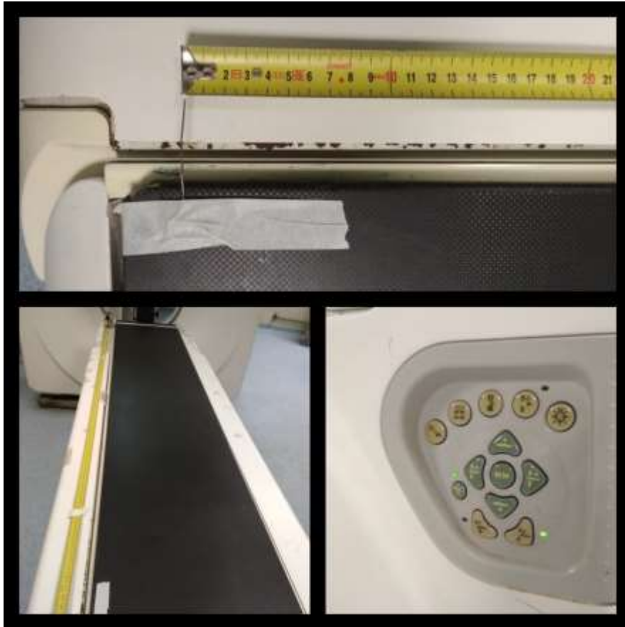
Figura 10: Trena sobre a mesa do tomógrafo para teste de verificação do indicador de posição da mesa.
