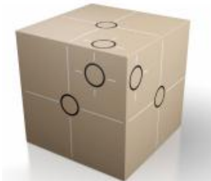
Figura 18 – Cubo Winston-Lutz com uma BB \varnothing 5 mm no isocentro e outra BB \varnothing 5 mm deslocada
