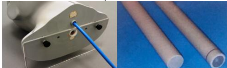
Figura 15 – Ilustração do posicionamento e do acesso do conduto equivalente a tecido mole para acomodar a câmara de ionização no Phantom Steev CIRS
