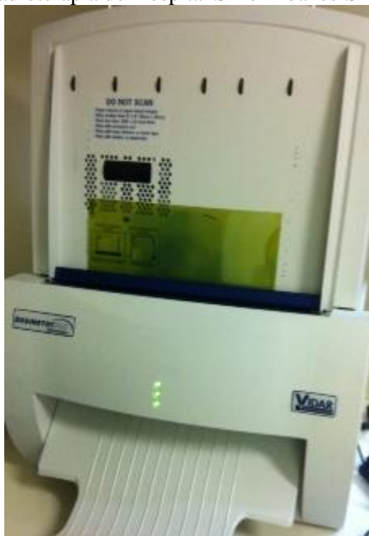
Figura 58 – Digitalizador DosimetryPro Advantage Scanner® Vidar do Departamento de Física da Radioterapia do Hospital Sírio-Libanês-SP
