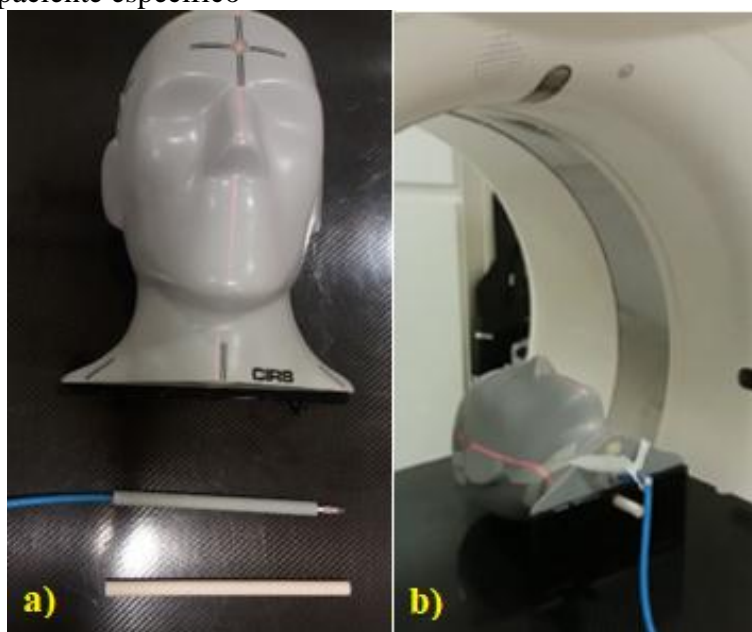
Figura 78 – Setup para Tomografia Computadorizada do Phantom Steev destinado aos planos de QA paciente específico
