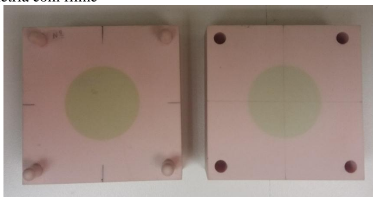
Figura 86 – Técnica para alinhamento do filme radiocrômico com o inserto cúbico para dosimetria com filme
