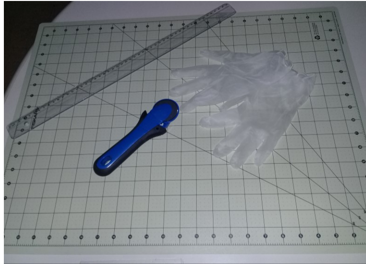
Figura 7 - Sistema de corte: base milimetrada, cortador giratório, luvas e régua
