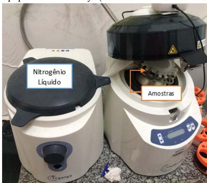
Nota: É colocado nitrogênio líquido no recipiente adequado sendo o mesmo transferido para o local onde as amostras estão inseridas. Isto permite que a temperatura se encontre no valor desejado, preservando as características da amostra.
