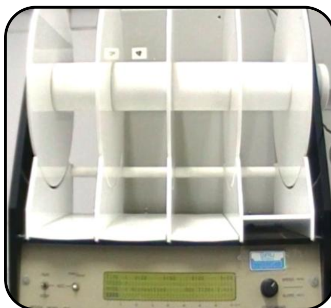
Figura 11 – Fotografia do aparelho para o teste do Rota Rod utilizado neste estudo
