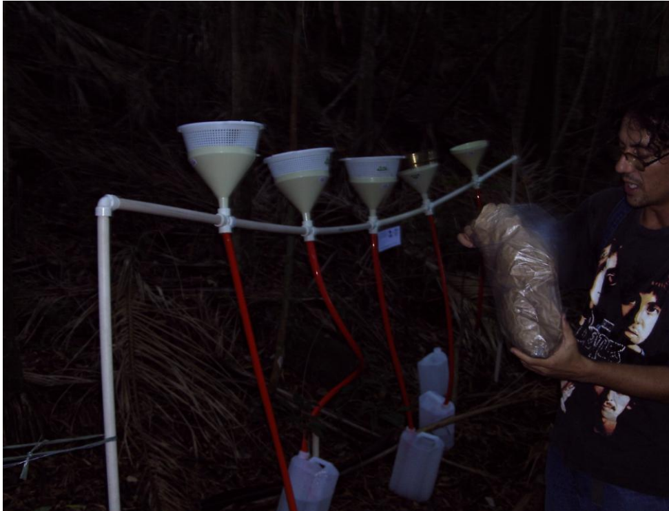
Fotografia 5 - Sistema de Pluviômetros no Experimento de Campo.
