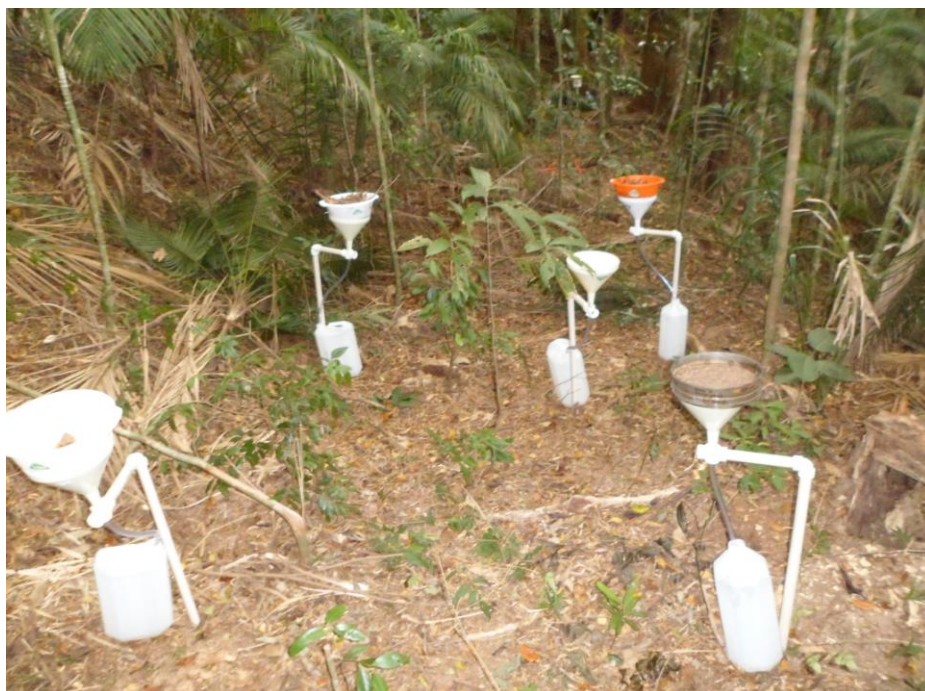
Fotografia 6 - Sistema de Pluviômetros no Método Final (ao fundo vemos o pluviômetro eletrônico).
