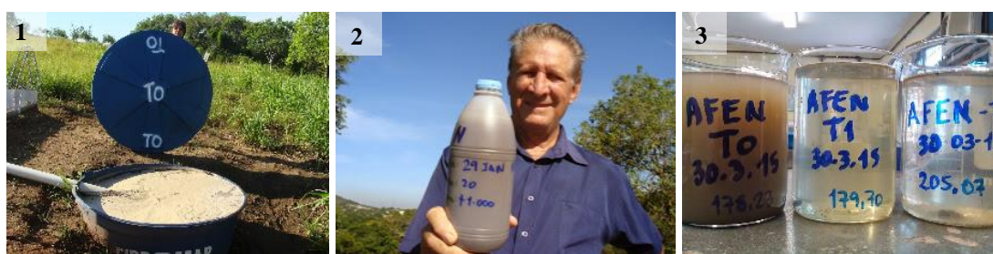
Figura 16 - Mosaico de fotografias. (1) abertura de caixa coletora após evento de chuva; (2) coleta de amostra; (3) beckers com amostras para análise no LabGeo. Fonte: o Autor, 2014.
