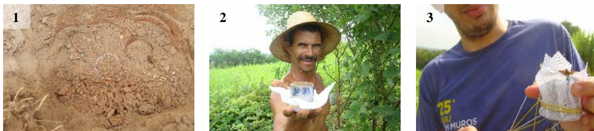
Figura 20 - Mosaico de fotografias. (1) anéis de Kopecky cravados na matriz do solo na trincheira; (2) amostra indeformada coletada da trincheira; (3) fundo do anel protegido por morim. Fonte: o Autor, 2014.
