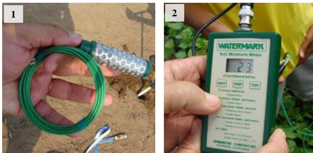
Figura 1- Mosaico de fotografias (1) Bloco de Matriz Granular - GMS e (2) Medidor Digital Watermak® – Fonte: O autor, 2014
