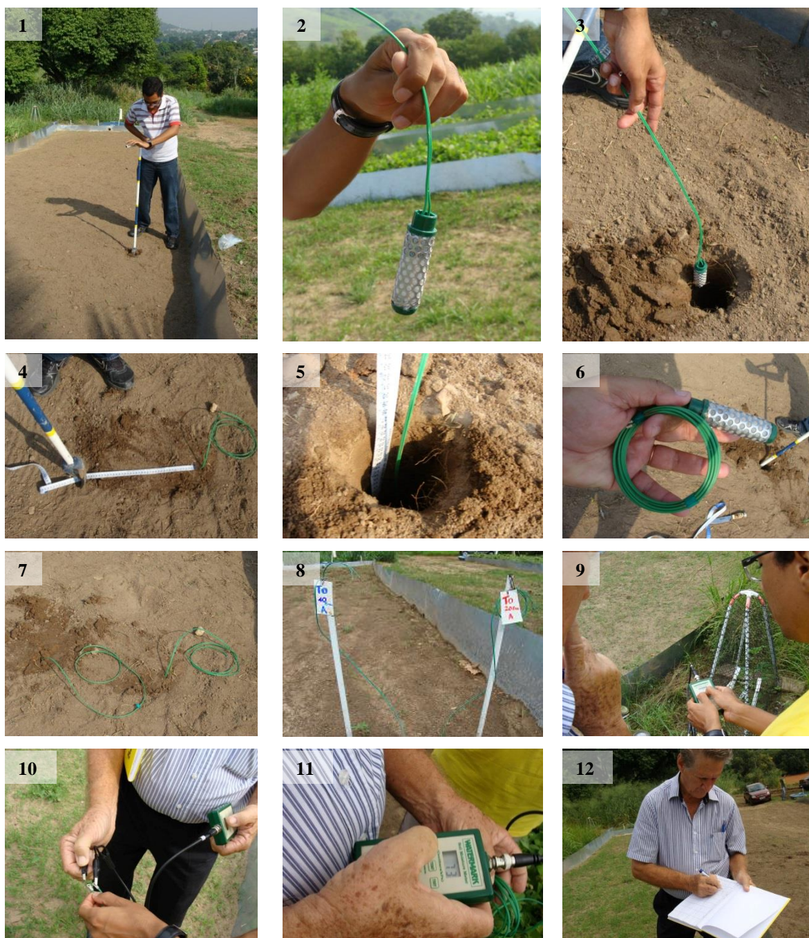
Figura 26 - Mosaico de fotografias. (1) abertura de furo; (2) GMS; (3) e (4) instalação do GMS a 20 cm; (5), (6) e (7) instalação do segundo GMS a 40 cm; (8) identificação e separação de terminais de leitura dos GMSs; (9) leitura do geotermômetro e aferição do leitor digital; (10) engate dos terminais do leitor nos terminais do GMS; (11) e (12) leitura e anotação dos valores; Fonte: o Autor, 2014.
