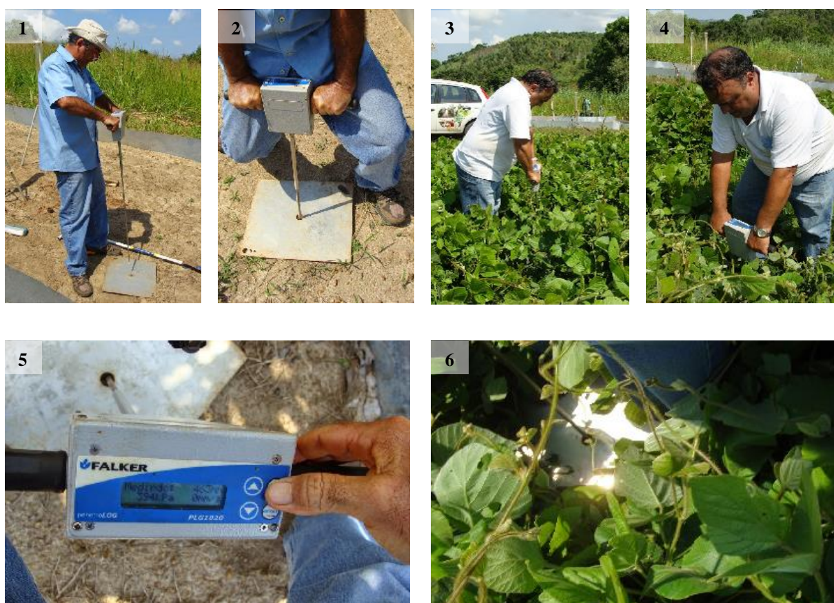
Figura 24 - Mosaico de fotografias dos testes de resistência do solo à penetração. (1) e (2) teste do penetrógrafo na parcela T0, com destaque para a base refletora; (3) e (4) teste do Penetrógrafo na parcela T1; (5) display de interface do aparelho; (6) base refletora do aparelho. Fonte: o Autor, 2015.
