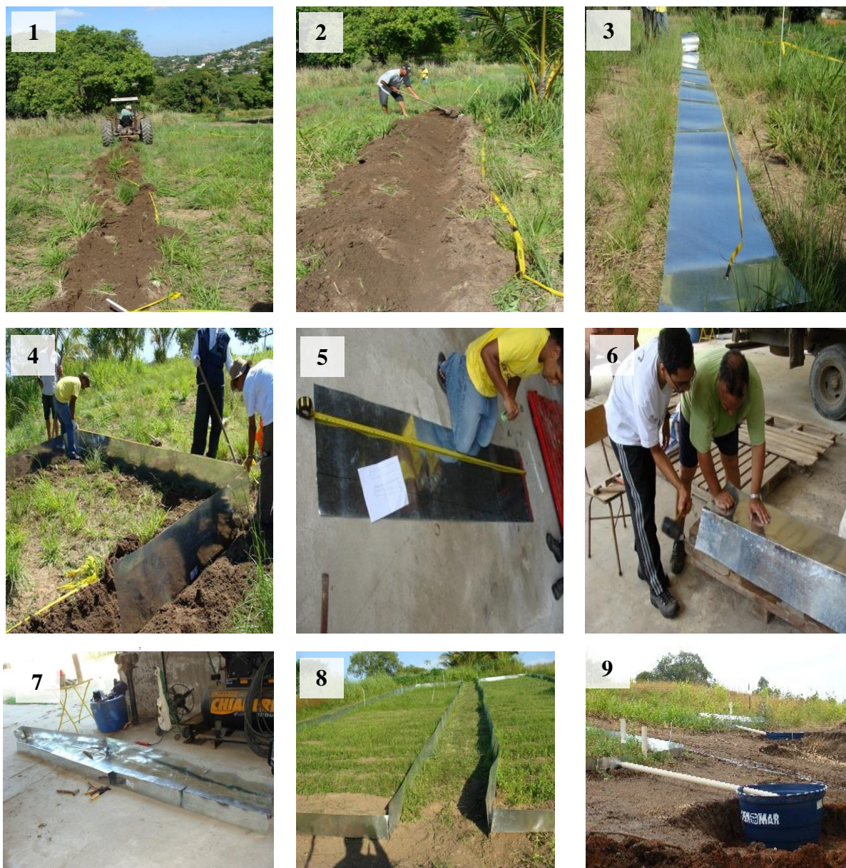
Figura 10 - Mosaico de fotografias da instalação das parcelas de erosão. (1) e (2) abertura de sulcos; (3) medições e cortes das chapas; (4) fixação das chapas ao solo, (5), (6) e (7) confecção e montagem da cabeceira; (8) parcelas instaladas; (9) parcelas com sistema de coleta de sedimentos instalados. Fonte: o Autor, 2013.
