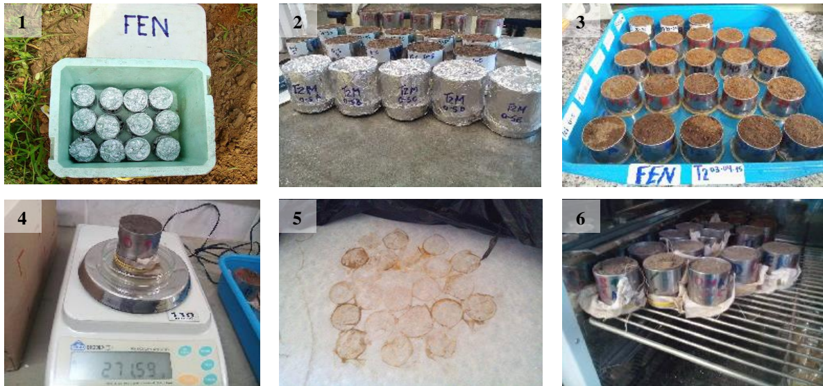
Figura 21 - Mosaico de fotografias: (1) transporte de amostras embaladas em papel alumínio; (2) amostras identificadas chegam ao laboratório; (3) amostras identificadas em saturação; (4) pesagem de amostra; (5) mesa de tensão com papel mata-borrão; (6) secagem de amostras em estufa a 105 °C. Fonte: o Autor, 2015.
