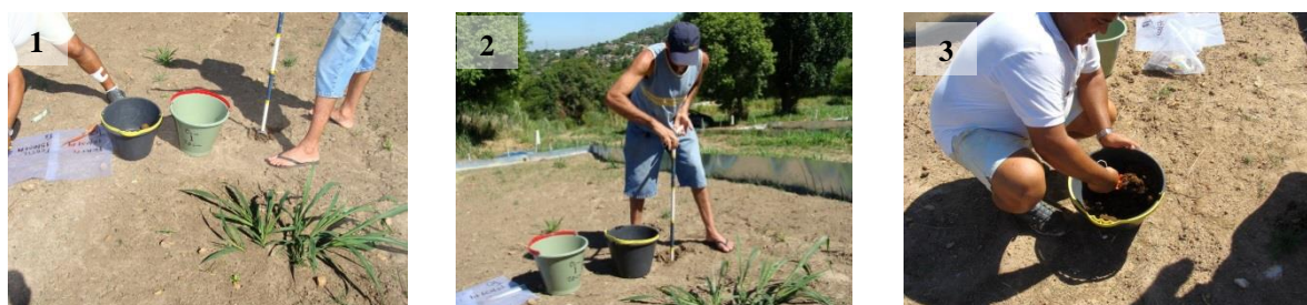
Figura 22 - Mosaico de fotografias de coleta de amostras deformadas nas parcelas. (1) identificação de embalagens e de baldes coletores; (2) coleta de amostras com trado holandês; (3) homogeneização de amostras simples para retirada de amostra composta. Fonte: o Autor, 2014.
