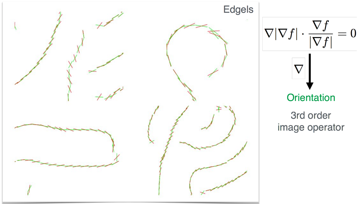
Figura 9 - Detector de elementos de borda subpíxel.
