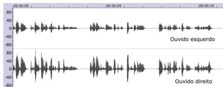
Figura 7.22: Amplitude versus tempo do som gravado no processo de auralização (arquivo .wav) para a Cabeça Virtual 1.
