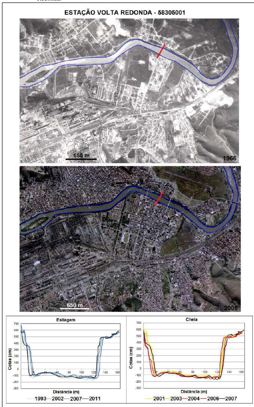
Figura 114 – Perfis transversais dos períodos da estiagem e da cheia da estação fluviométrica Volta Redonda.
