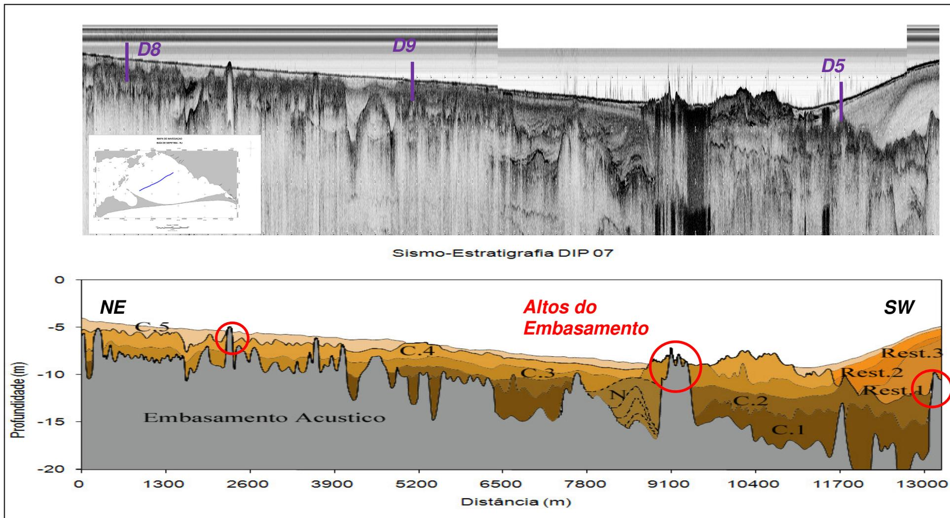
Figura 38 - Dado bruto e interpretação dos horizontes sísmicos do perfil D7. Os círculos em vermelho mostram os altos do embasamento acústico. O traçado roxo mostra o cruzamento com os perfis D5, D8 e D9.
