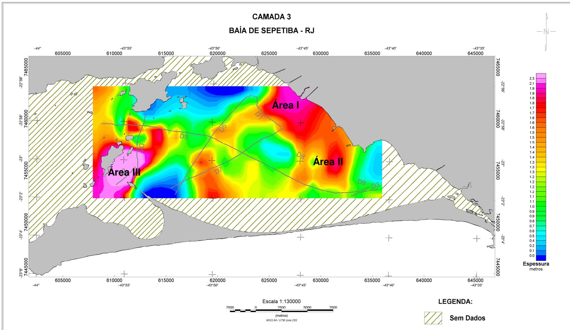
Figura 47 - Mapa de Isópacas da Camada 3. Em tons de azul, as menores espessuras e em tons de rosa, as maiores. Posicionamento das linhas sísmicas em cinza.
