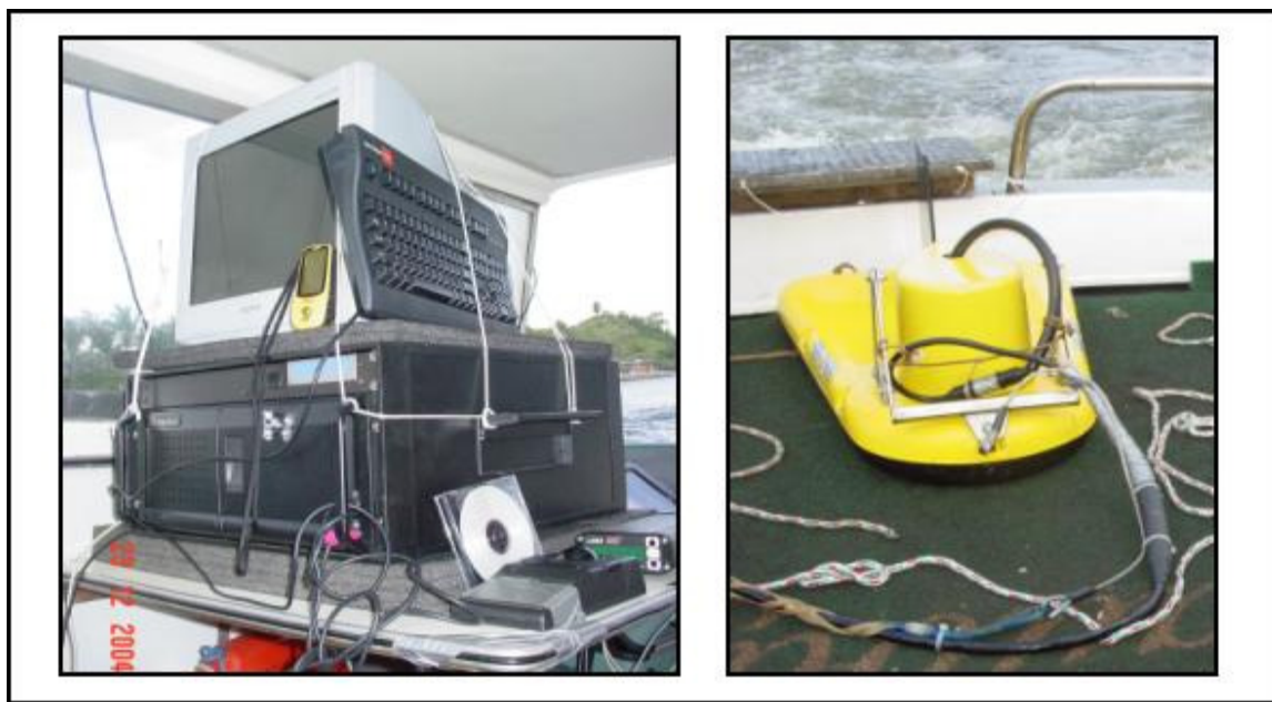
Figura 20 - Da esquerda para a direita: Sistema de geof sica rasa de alta resolu  o e fonte de emiss  o e recebimento do sinal ac stico.
