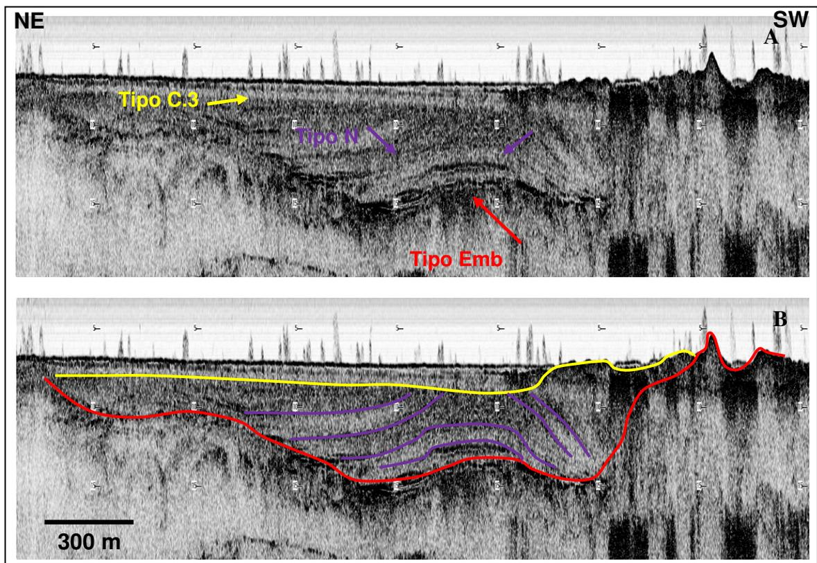
Figura 30 - A – Exemplos dos Refletores N, BF e Emb encontrado nos perfil sísmico D7; B – Horizontes sísmicos interpretados.
