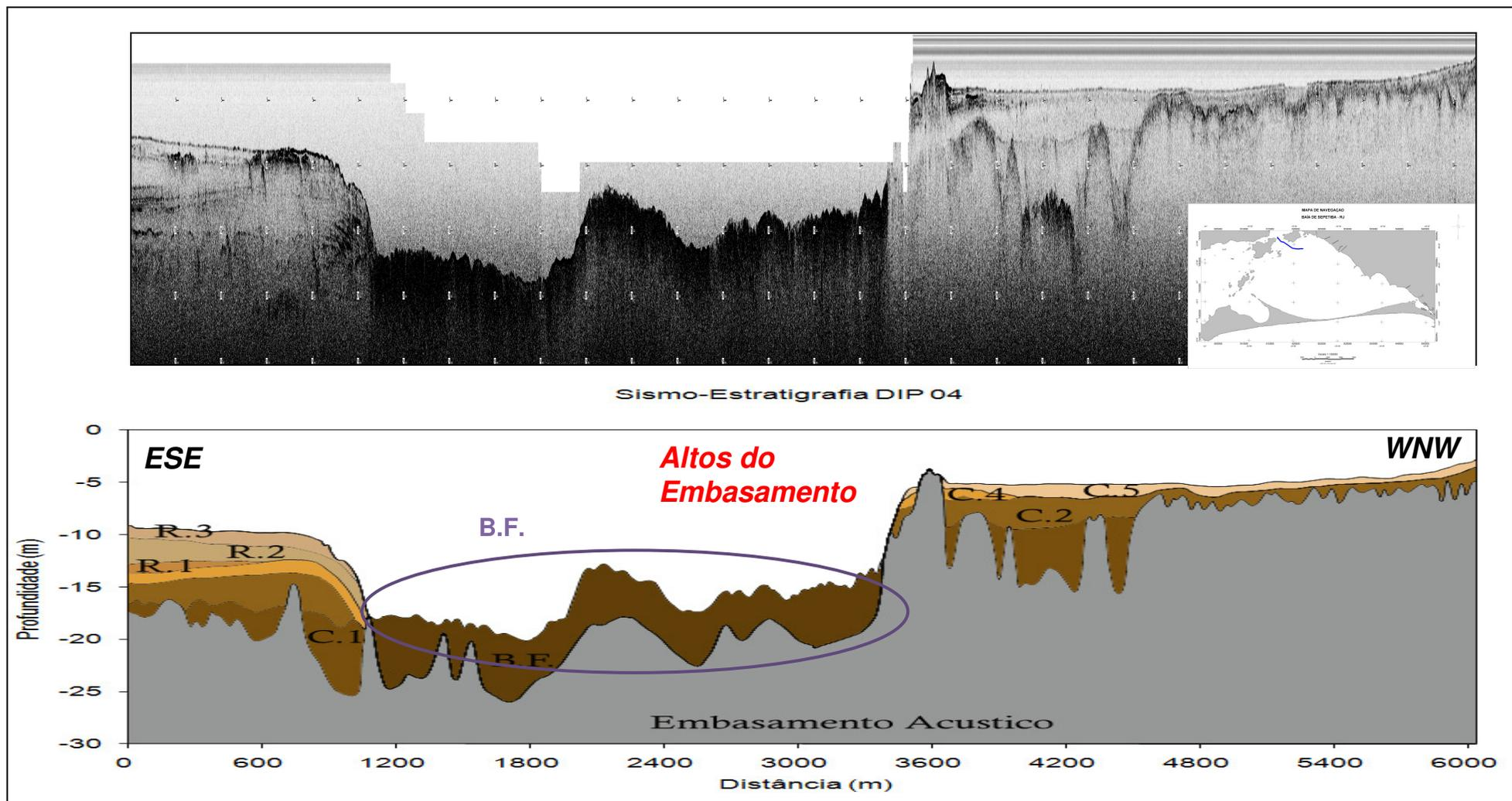
Figura 35 - Dado bruto e interpretação dos horizontes sísmicos do perfil D4. O círculo em vermelho mostra os altos do embasamento acústico. E o roxo, a área de descarte (B.F.).
