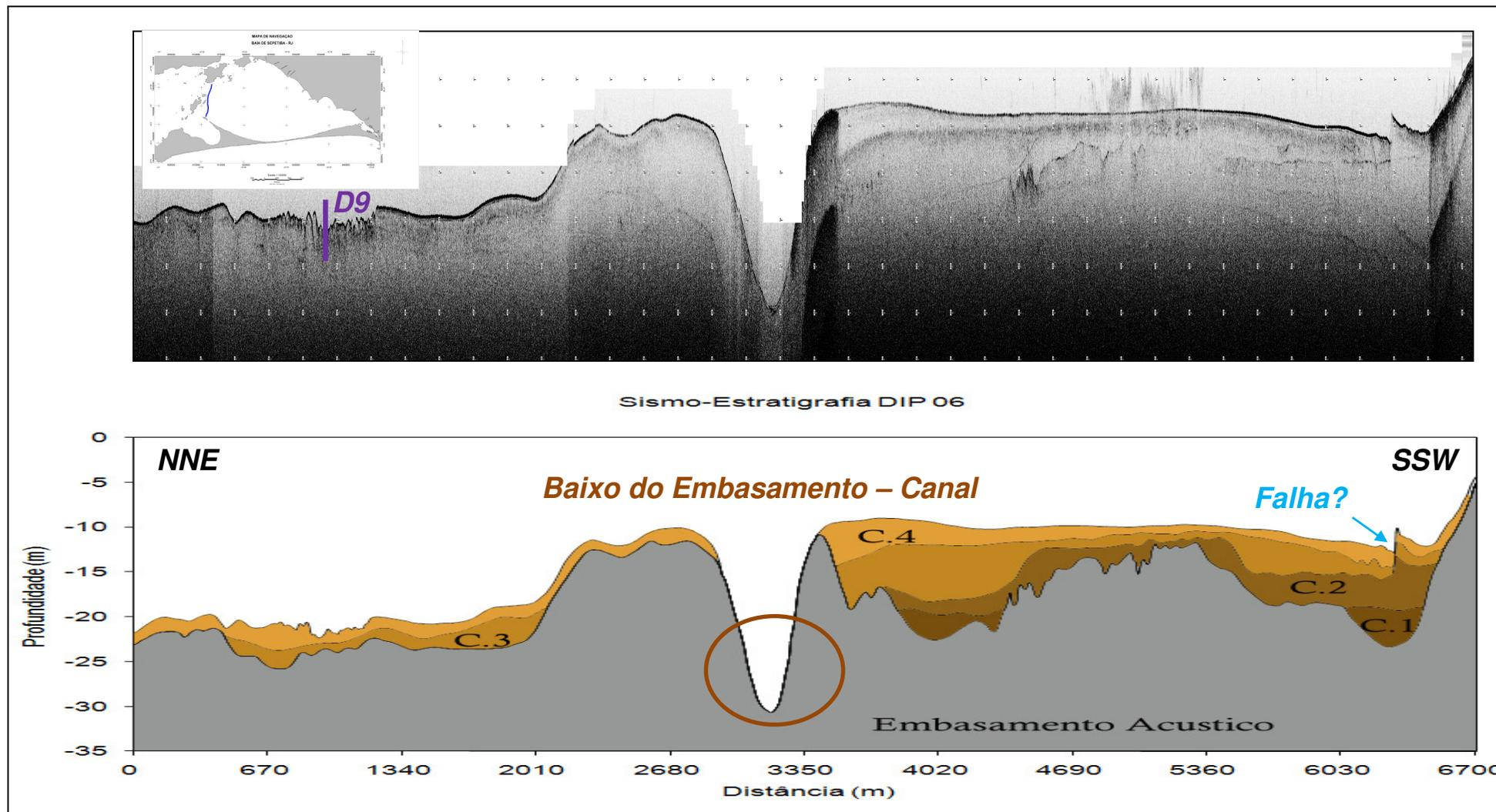
Figura 37 - Dado bruto e interpretação dos horizontes sísmicos do perfil D6. O círculo em marrom mostra o baixo do embasamento. A seta em azul, uma possível falha. O traçado roxo mostra o cruzamento com o perfil D9.
