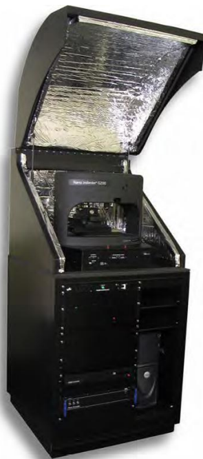
Figura 5 – Nanoindentador G200 Agilent
