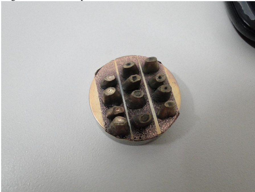
Legenda: Stub com as amostras com banho de ouro Fonte: O autor, 2017.
