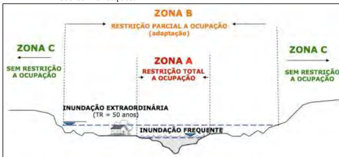
Figura 40- Modelo conceitual utilizado pelo Inea para definição do zoneamento de risco de inundações.
