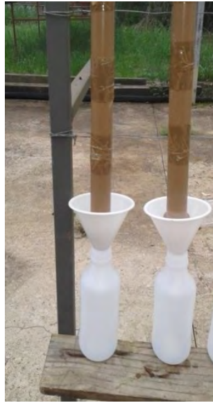
Figura 16 – Confeção e estabelecimento das colunas de solo
