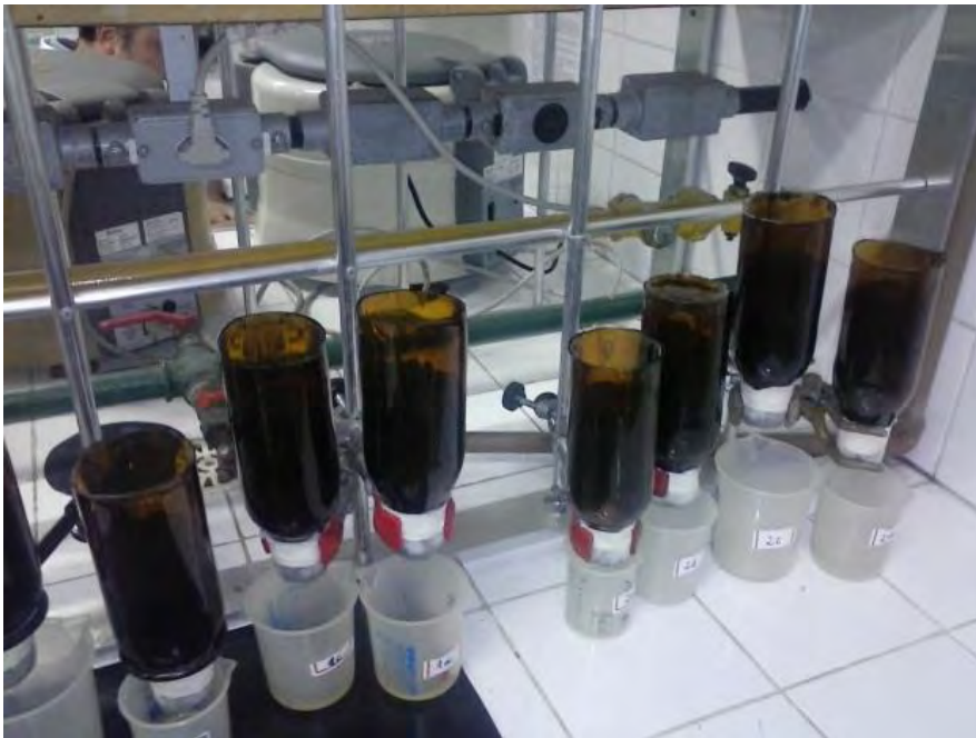
Figura 5 – Confeção de coluna para saturação de solo
