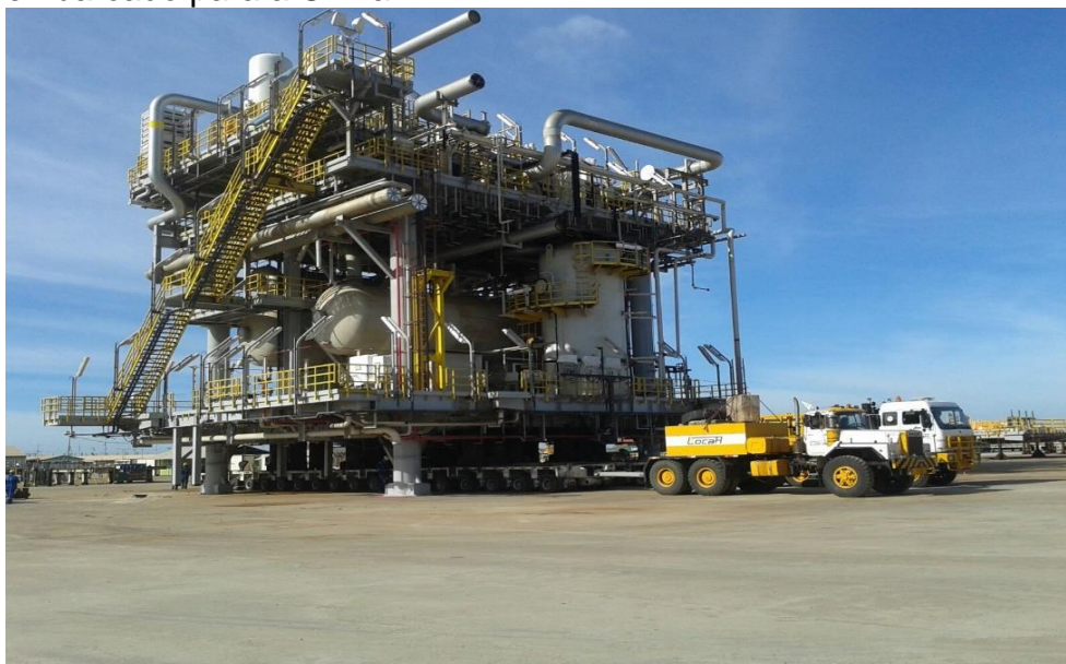
Foto 27 - Módulo montado pelo Consórcio Integra no Aço e embarcado para a China.
