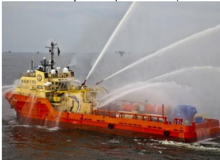
Foto 16 - Embarcações de apoio offshore (PSV e OSRV)
