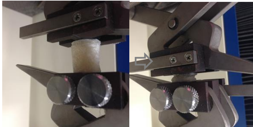
Figura 17 – Ensaio de compressão em máquina universal de ensaio Emic DL 2000
