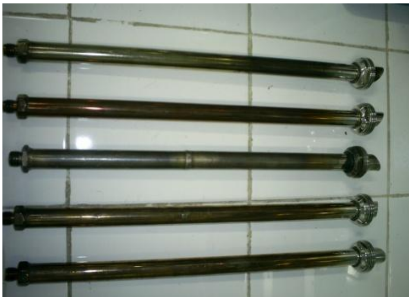
Figura 10: Reatores de aço inox utilizados nos experimentos de pirólise.
