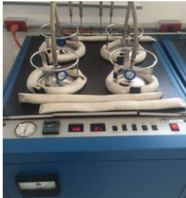
Figura 13 - Sistema de limpeza dos canisters
