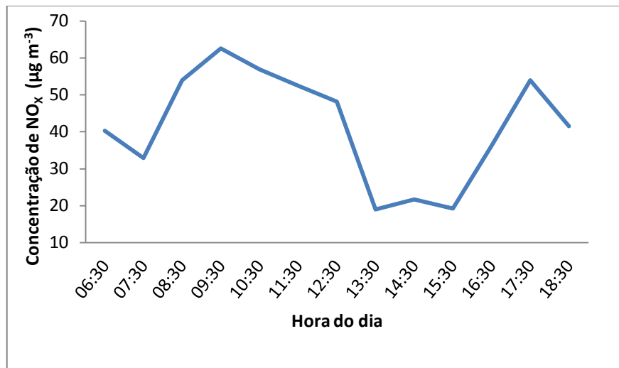
Figura 20 - Valores experimentais de concentração de \text{NO}_x (em unidades de \mu\text{g m}^{-3} ), em função das horas do dia para o dia do episódio de ozônio
