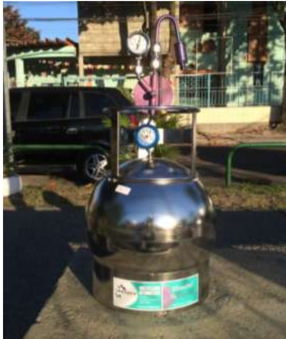
Figura 12 - Canister com restritor de fluxo
