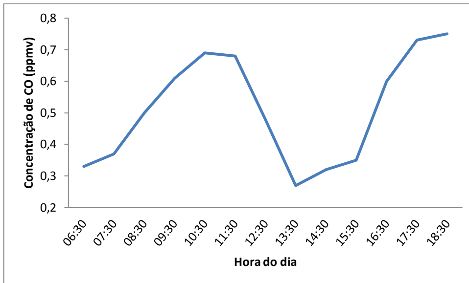
Figura 19 - Valores experimentais de concentração de CO (em unidades de ppmv), em função das horas do dia para o dia do episódio de ozônio
