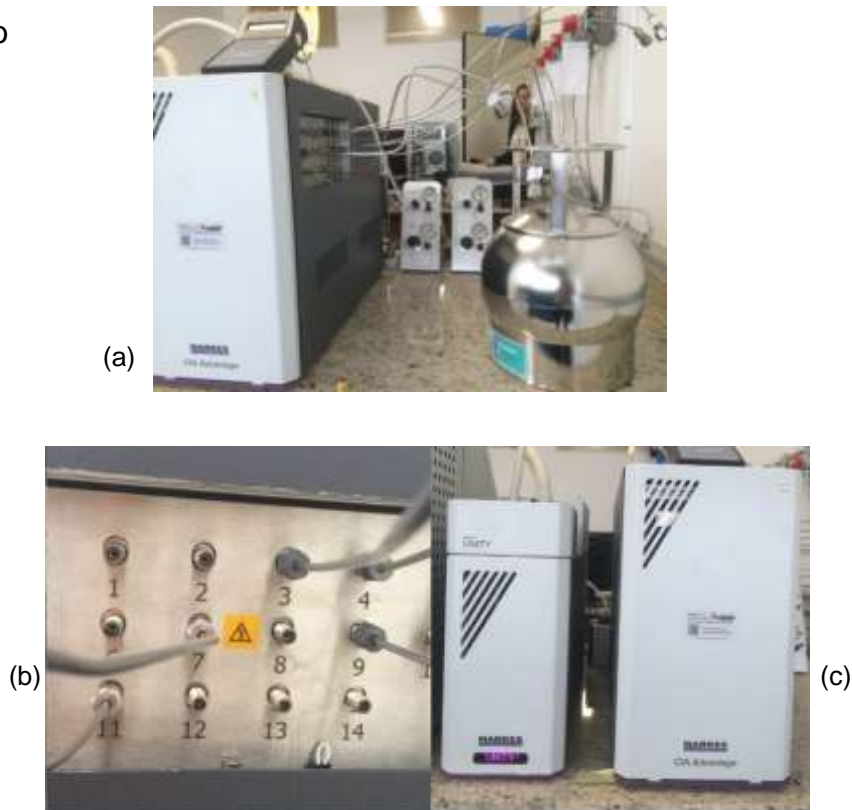
(a) Canisters conectado à unidade amostradora. (b) canais de conexão entre os canisters e a unidade amostradora. (c) Unidade amostradora de canisters CIA Advanced.
